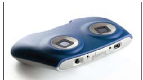
Рис. 13. PS25503 Impulse — демонстрационный набор с ПО для передачи ЭКГ по каналу Bluetooth на устройства с ОС Android
